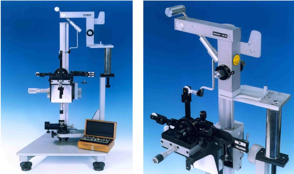
Bild 4.3: Kreuzbalkenwaage zur Prüfung von Applanationstonometern;
